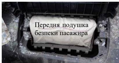
Рис. 4. Загальний вигляд неактивованої передньої (фронтальної) подушки безпеки пасажирів автомобіля KIA-Carens
