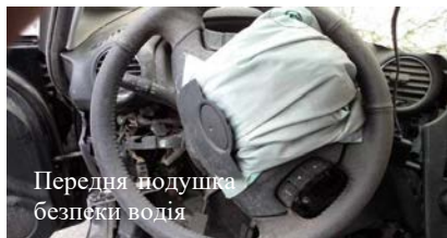
Рис. 3. Загальний вигляд активованої передньої (фронтальної) подушки безпеки водія автомобіля KIA-Carens
