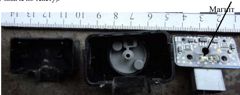
Рис. 7. Вигляд вимикача передньої (фронтальної) подушки безпеки пасажирів автомобіля KIA-Carens (в розібраному стані)
