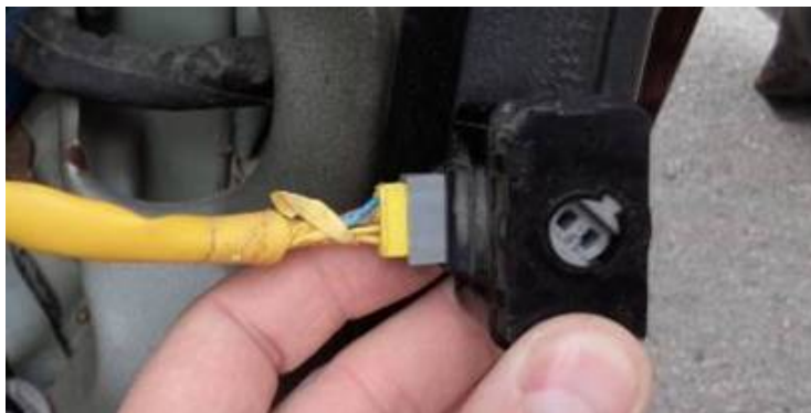
Рис. 6. Вигляд вимикача передньої (фронтальної) подушки безпеки пасажирів досліджуваного автомобіля KIA-Carens
