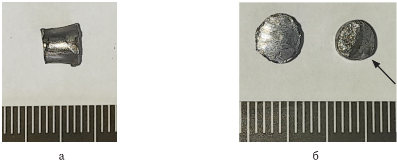
Рис. 25. Загальний вигляд готового уражаючого елемента після влучання в блок балістичного пластиліну та порівняння із недеформованим зразком (позначено стрілкою)
