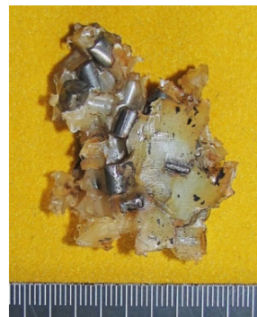
Рис. 2. Загальний вигляд готових уражаючих елементів циліндричної форми міни ОЗМ-72 (а) і фрагмента полімерної сорочки, у яку їх залито (б)
