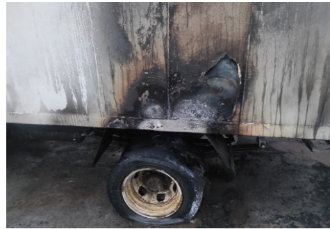
Рис. 5, 6. Відображення локальних слідів поверхневого вигорання рідини
