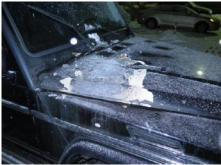
Рис. 5, 6. Відображення локальних слідів поверхневого вигорання рідини
