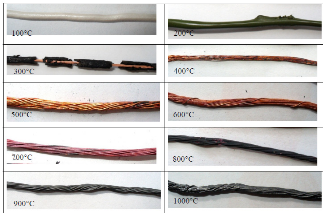
Рис. 1. Зовнішній вигляд мідних багатожильних провідників зі слідами термічного впливу за різних температур
