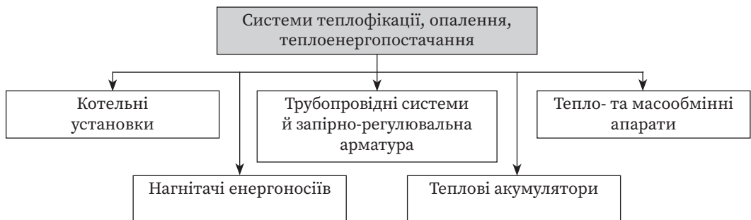
Рис. 2. Структура складного системного об'єкта дослідження судової теплотехнічної експертизи
