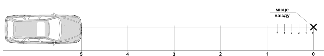
Рис. 1. Визначення видимості за відсутності світла фар зустрічного ТЗ
