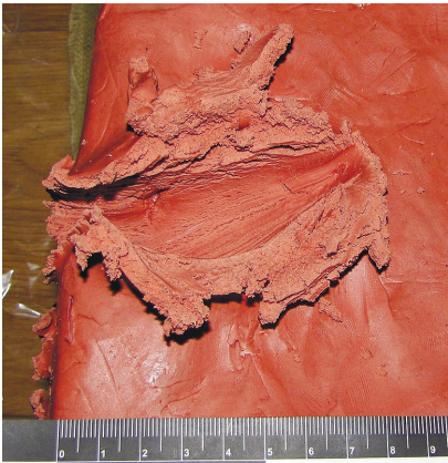
Рис. 13. Поздовжній перетин пошкодження блока балістичного пластиліну, позначеного як «1»
