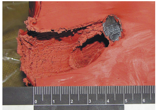
Рис. 17. Поздовжній перетин пошкодження блока балістичного пластиліну, позначеного як «5»
