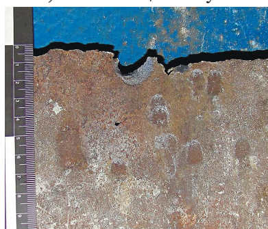
Рис. 5. Сліди рикошету на поверхні металевій плити, спричинені влучанням 5,6 мм свинцевих куль
