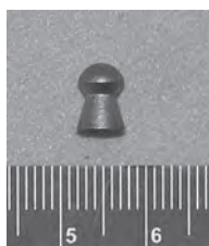
Рис. 2. Общий вид пули Jumbo Heavy Diabolo калибра 5,5 мм, использованной для проведения экспериментальных стрельб
