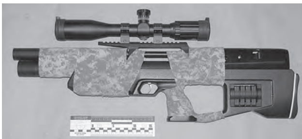
Рис. 1. Вид справа а и слева б пневматической РСР винтовки Cricket в исполнении «пластик» калибра 5,5 мм
