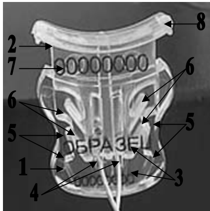
Рис. 1. Загальний вигляд охоронної пломби «Граніт», де 1 – корпус; 2 – якір; 3 – нанесені восьмизначний номер і логотип на корпусі пломби; 4 – отвори для протягування пломбувального тросу; 5 – фіксуєючі виступи; 6 – лапки якоря; 7 – дубльований восьмизначний номер на остові якоря; 8 – кришка якоря
