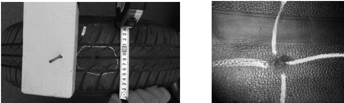
Рис. 6. Отвір в автомобільній шині, створений цвяхом \varnothing 3,5 мм
