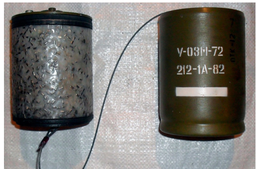
Рис. 1. Загальний вигляд осколкової загороджувальної міни ОЗМ-72 (фото із мережі «Інтернет»)
