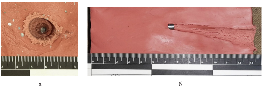
Рис. 12. Характер пошкодження балістичного пластиліну після влучання досліджуваного уражаючого елемента за контактної швидкості 251,4 м/с
