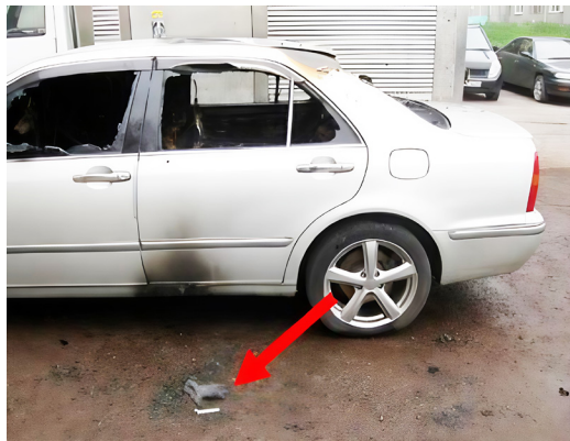
Рис. 3, 4. Зображення слідів вигорання рідини та рукавичка із фрагментами скління автомобіля
