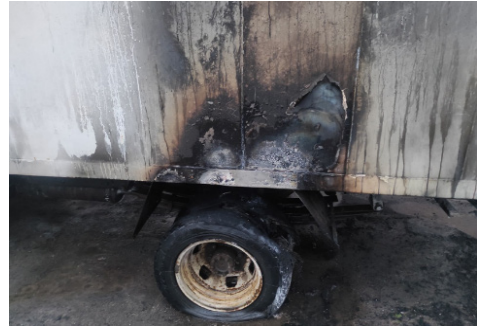
Рис. 5, 6. Відображення локальних слідів поверхневого вигорання рідини
