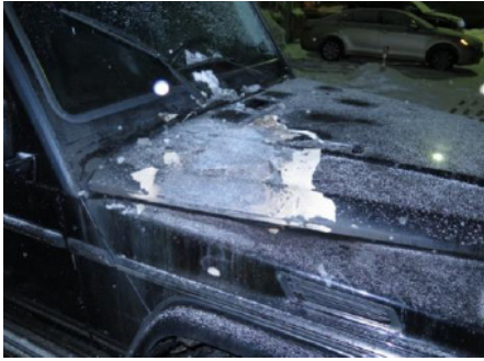
Рис. 5, 6. Відображення локальних слідів поверхневого вигорання рідини
