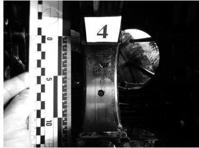
Рис. 2. Руйнування й викришування антифрикційного шару
