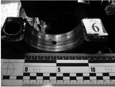
Рис. 1. Великі кільцеві риски внаслідок подряпин
